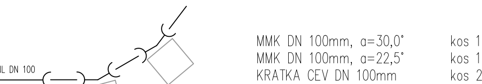
76 Horizontalni lom 22,50°+24,50° in vertikalni lom 11°
