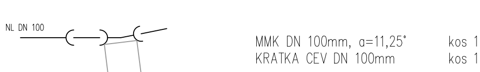
75 Horizontalni lom 11,25° in vertikalni lom 13°
