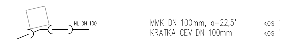
76 Horizontalni lom 22,50°+24,50° in vertikalni lom 11°
