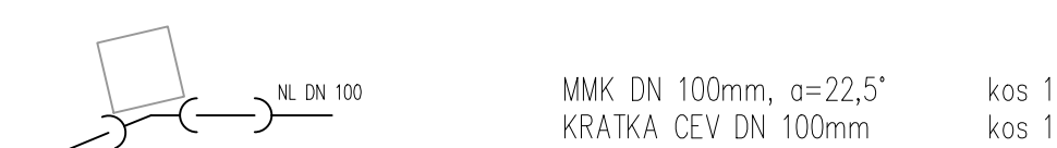
80 Horizontalni lom 11,25° in vertikalni lom 13°
