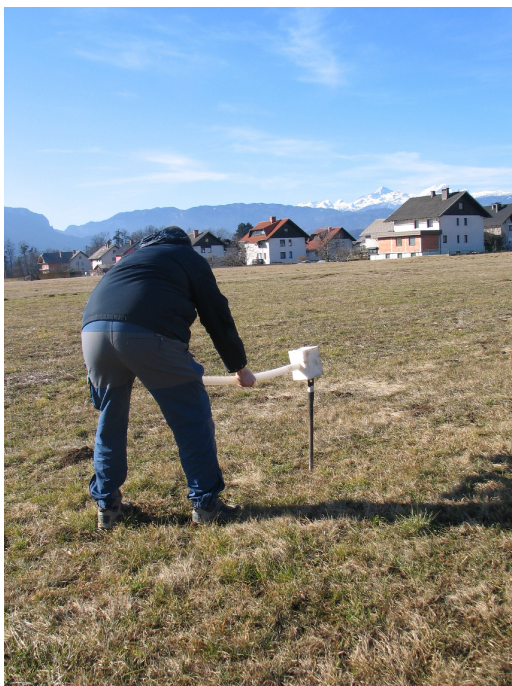
Slika 5: Prikaz sondiranja tal s pomočjo žlebičaste sonde (vir: Kralj, 2008)
