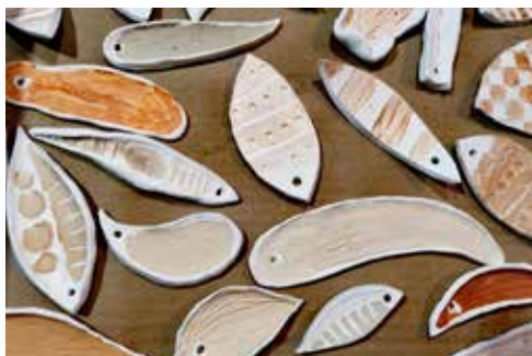
Glinene ploščice za ugotavljanje obnašanja naravne barve (vzorci zemlje)
