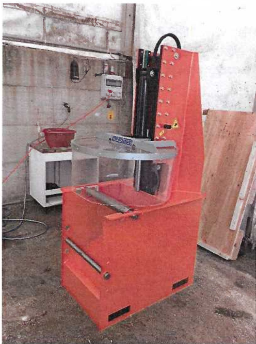
Slika: Naprava za odstranjevanje platišč odvrženih skupaj s pnevmatikami
