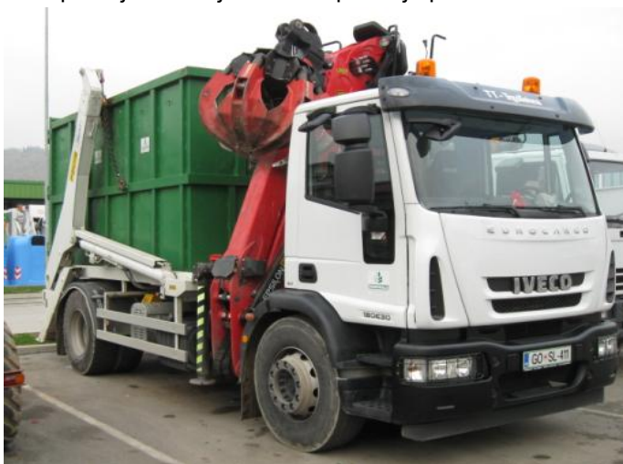
Slika : Samonakladalec z žerjavom
