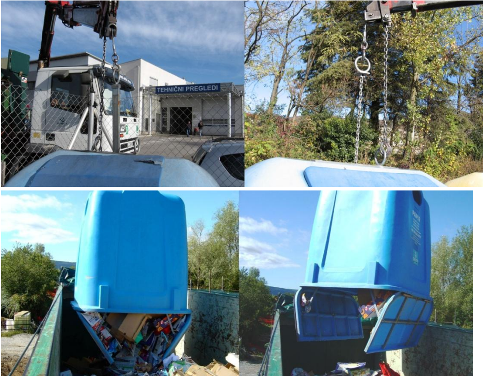
Slika : Dvigovanje in praznjenje zvana po pritrditvi žične vrvi in verige na zvon
