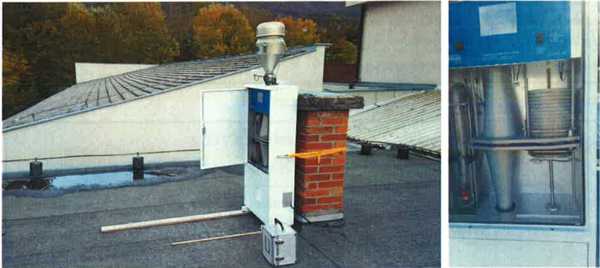
Slika 2: vzorčevalnik Digitel DHA-80 na strehi OŠ Deskle (levo). Filtri v vzorčevalniku, pripravljeni za vzorčenje (desno).
